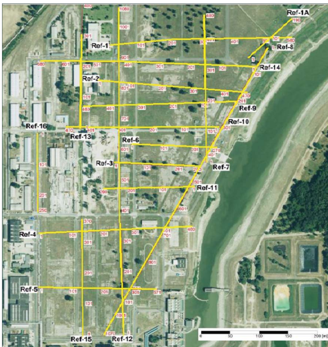
2. ábra. Az SRef jelű sekély szeizmikus S-hullám-mérések helyszínrajza (Tóth et al. (2016) adatainak felhasználásával)
